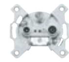
zásuvka TV+R+SAT průběžná, útlum 10 dB, 300 mA, 24 V DC pro koaxiální kabely průměru 4,5–8,3 mm typové označení na výrobku: ZAR-SAT 10/P3
