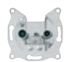
zásuvka TV+R koncová, útlum 1 dB, 350 mA, 24 V DC pro koaxiální kabely průměru 4,5–8,3 mm typové označení na výrobku: ZAR 1/K
