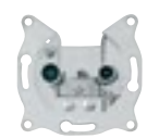
zásuvka TV+R průběžná odbočovací útlum 14 dB pro koaxiální kabely průměru 4,5–8,3 mm typové označení na výrobku: ZAP 14
