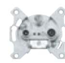
zásuvka TV+R+SAT průběžná, útlum 10 dB, 300 mA, 24 V DC pro koaxiální kabely průměru 4,5–8,3 mm typové označení na výrobku: ZAR-SAT 10/P3
