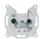
zásuvka TV+R průběžná odbočovací útlum 9 dB pro koaxiální kabely průměru 4,5–8,3 mm typové označení na výrobku: ZAP 9/K
