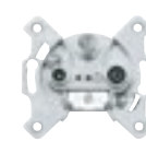
zásuvka TV+R+SAT koncová, útlum 1 dB, 300 mA, 24 V DC pro koaxiální kabely průměru 4,5–8,3 mm typové označení na výrobku: ZAR-SAT 1,4/K
