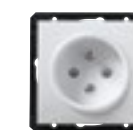
zásuvka 2P+PE jednonásobná s dětskou ochranou 16 A, 250 V AC
