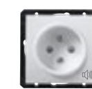
zásuvka 2P+PE s PO jednonásobná s dětskou a přepětovou ochranou (ZVUKOVÁ SIGNALIZACE), 16 A, 250 V AC
