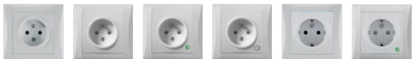
zásuvka jednonásobná (2P+PE) zásuvka jednonásobná s dětskou ochranou (2P+PE) zásuvka jednonásobná s dětskou ochranou a přepětovou ochranou (2P+PE) SVĚTLNÁ SIGNALIZACE zásuvka jednonásobná s dětskou ochranou a přepětovou ochranou (2P+PE) ZVUKOVÁ SIGNALIZACE zásuvka jednonásobná schuko (2P+PE) zásuvka jednonásobná schuko s dětskou ochranou a přepětovou ochranou (2P+PE) SVĚTLNÁ SIGNALIZACE
