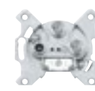
zásuvka TV+SAT+SAT průběžná, útlum 10 dB, 300 mA, 24 V DC pro koaxiální kabely průměru 4,5–8,3 mm typové označení na výrobku: ZAR-SAT 10/P3
