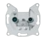
zásuvka TV+R koncová, útlum 1 dB, 350 mA, 24 V DC pro koaxiální kabely průměru 4,5–8,3 mm typové označení na výrobku: ZAR1/K
